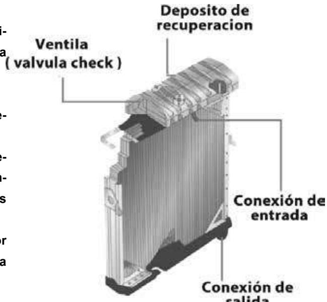
Tapa de radiador: Es usada en todos los motores modernos. La tapa se bloquea con el cuello del interno del radiador, el empaque ya sea de caucho o metal brinda el embone ideal para cerrar a presión.
